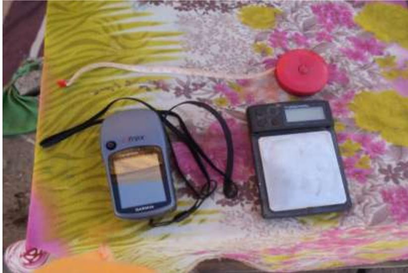
**Figure 9 :** Matériels utilisés : mètre ruban, GPS et balance numérique (BEZATO, 2013)
