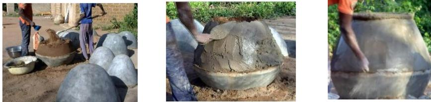
Du sable mouillé est utilisé pour monter la paroi et remplissage de sable sec. Crépissage et lissage de la paroi de sable
