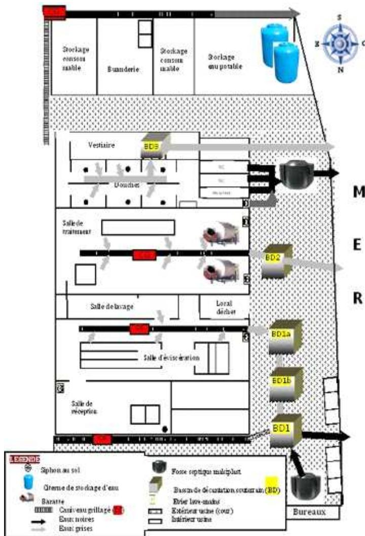
Figure 18 : Système d'évacuation d'eaux usées de Copefrito (Source : RAZAFINDRAVAO, 2010)
