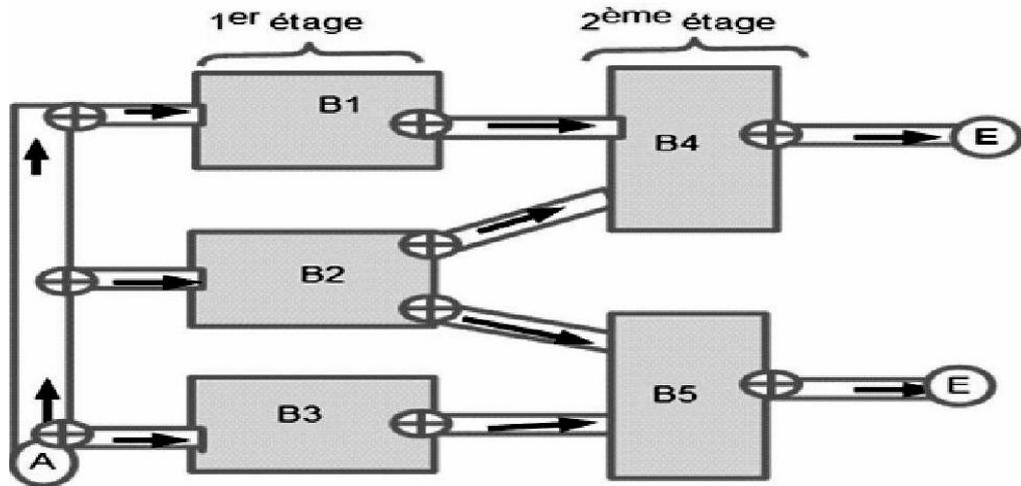
**Figure 42** : Schéma d'un projet de station d'épuration ; A : Arrivée des eaux grises à traiter ; E : Évacuation des eaux traitées ; B : Bassins.
