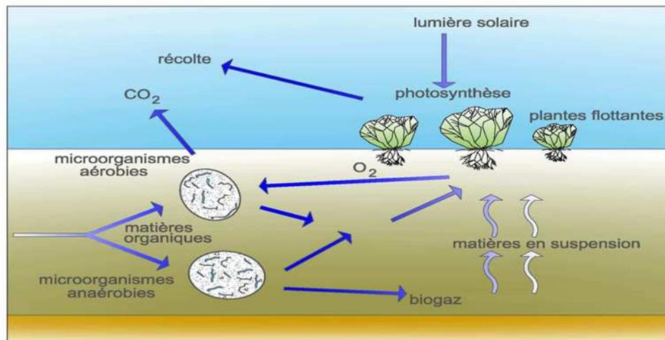
**Figure 4 :** Principes de l'épuration dans un bassin à macrophytes flottants (RAKOTOARISON, 2008)
