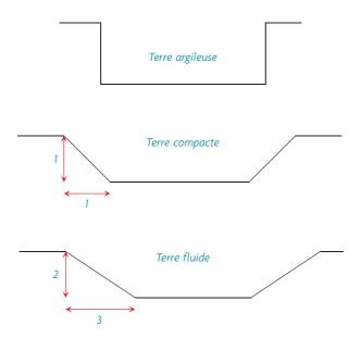
2 Les berges du bassin pourront avoir une pente de 3 de base pour 2 de hauteur si la terre de votre terrain est fluide, ou de 1 de base pour 1 de hauteur si la terre est compacte ou argileuse.
