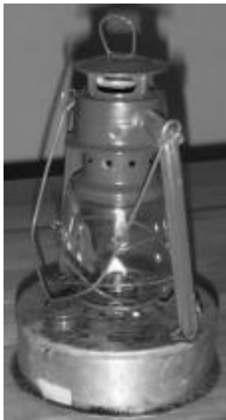
Photos 12 et 13 : lampe à pétrole modifiée pour utilisation avec de l'huile de Jatropha et « Binga-Oil-Lamp » développée par Binga Trees Trust (Henning, 2006)
