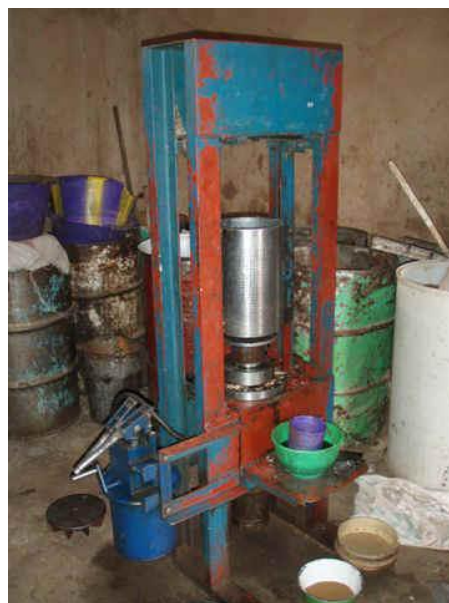
Photo 11 : presse hydraulique ADMGA, adaptée au Jatropha (source : site Internet Vivre au Village, projet Ingalan)
