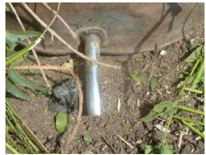
Récupération de l'huile et du goudron issus de la combustion lente du bois
