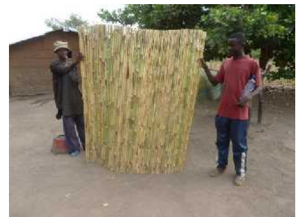
Nattes de tiges de sorgho pour la superstructure provisoire
