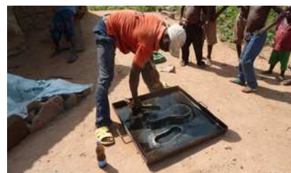
De l'huile de vidange est badigeonnée au fond du moule pour faciliter le démoulage
