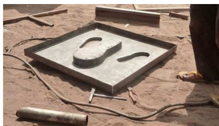
Moule en fer fabriqué par Bernardin, notre soudeur (sans les 2 poignées)
