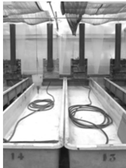
Photo 4: Auges d'alevinage en circuit ouvert avec tour de dégazage et tuyau échangeur de chaleur
