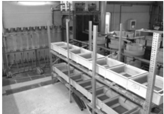
Photo 1: Ecloserie en circuit fermé: dans le fond, batterie de bouteilles de Zoug au-dessus du filtre bactérien pour l'éclosion des œufs et château d'eau et à l'avant plan, bacs de larviculture avec leurs claires
