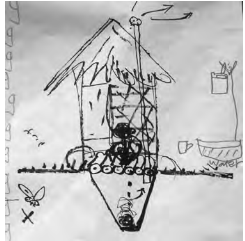
Croquis d'un modèle de latrine améliorée auto-ventilée dans le village de Kabengele en Zambie.
